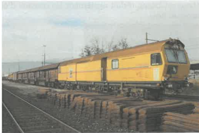
Train meuleur de rails (Scheuchzer S.A.)
